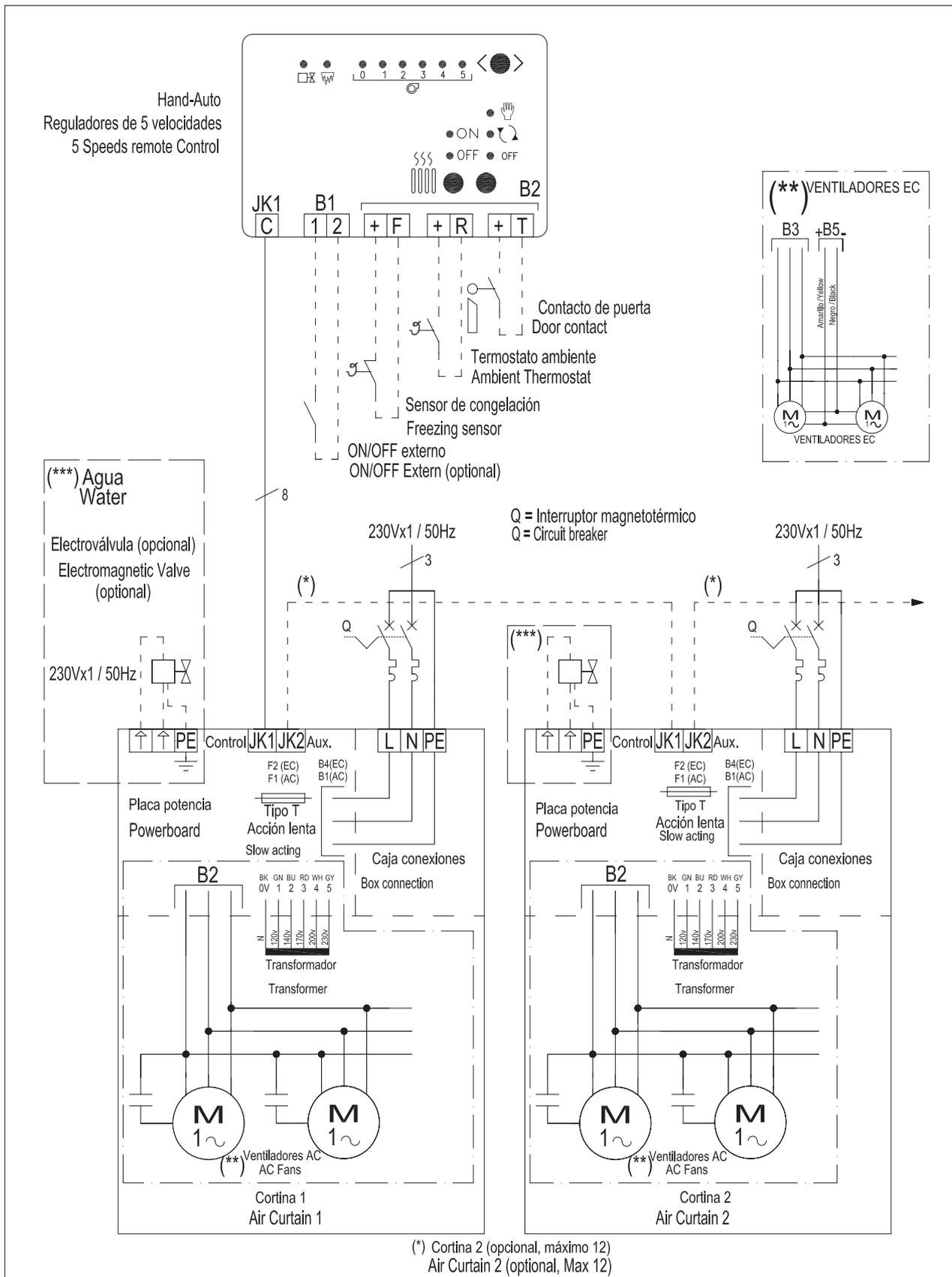
ESQUEMAS ELÉCTRICOS CORTINA DE AIRE VENTILADORES AC/EC
